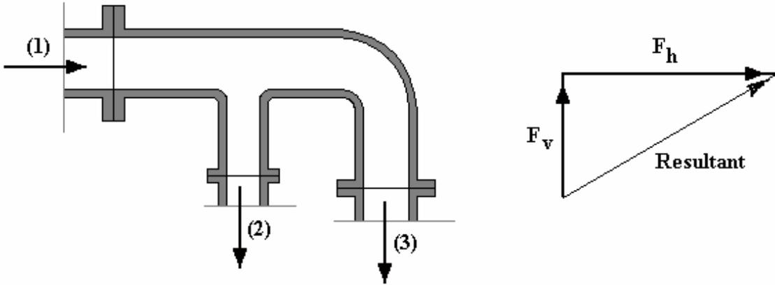
$$D_1 = 0.15\text{m} \quad D_2 = 0.05\text{m} \quad D_3 = 0.1\text{m} \quad Q_1 = 0.05 \text{ m}^3/\text{s}$$
